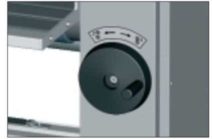
Manuelle Einstellung des Walzenspalts für Präzisionsarbeiten.
