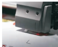
Ein Rotlicht-Marker positioniert den Werkzeugkopf punktgenau.
